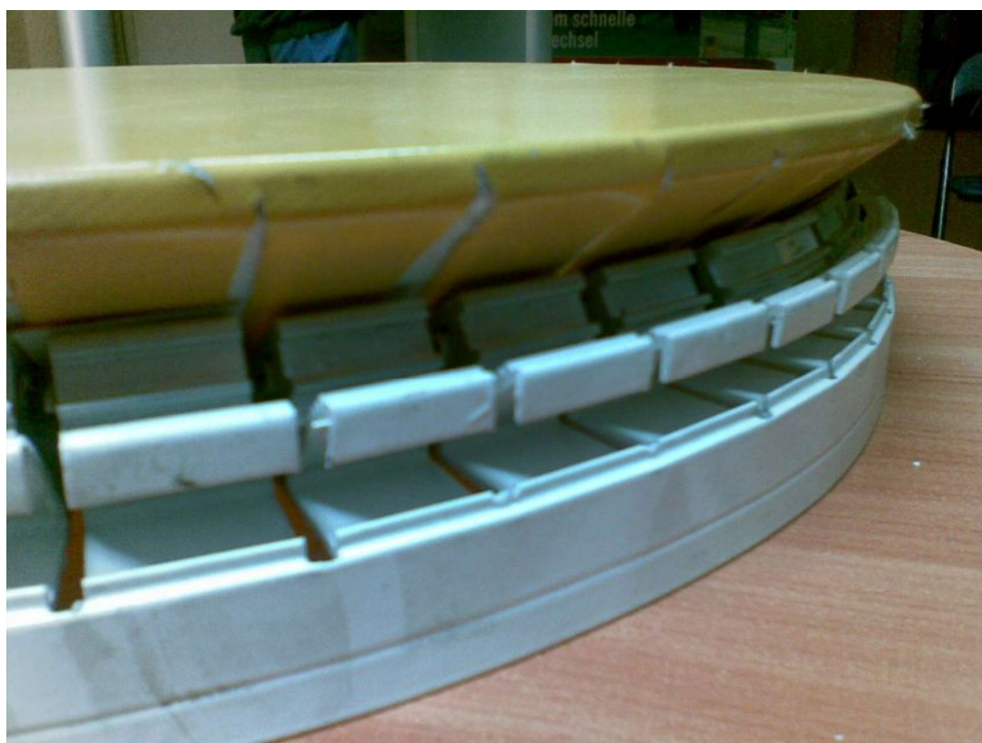
Fot. 7. Widok po napięciu tkaniny winylowej (należy mieć na uwadze, że im mniejszy promień łuku, tym więcej klipów wchodzi do ramy). Klipy należy ciąć na wymiar nie większy niż długość prostego odcinka ramy.
