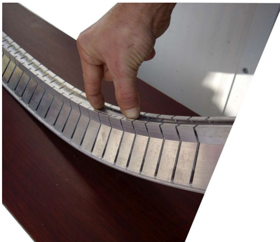
Fot.3. Przed kształtowaniem ramy do wymaganego kształtu należy wyciąć szablon (ze sklejki ok. 4mm lub PVC). Szablon może się składać z kilku połączonych ze sobą części. Na wyciętym szablonie formuje się wcześniej ponacinaną ramę napinającą. Żeby rama zachowała swój kształt po uformowaniu, należy wsunąć w prowadnice ramy płaskownik 15x2mm i przyspawać go punktowo do ramy ( Fot.5. ) w taki sposób, żeby rama się nie odkształcała.
